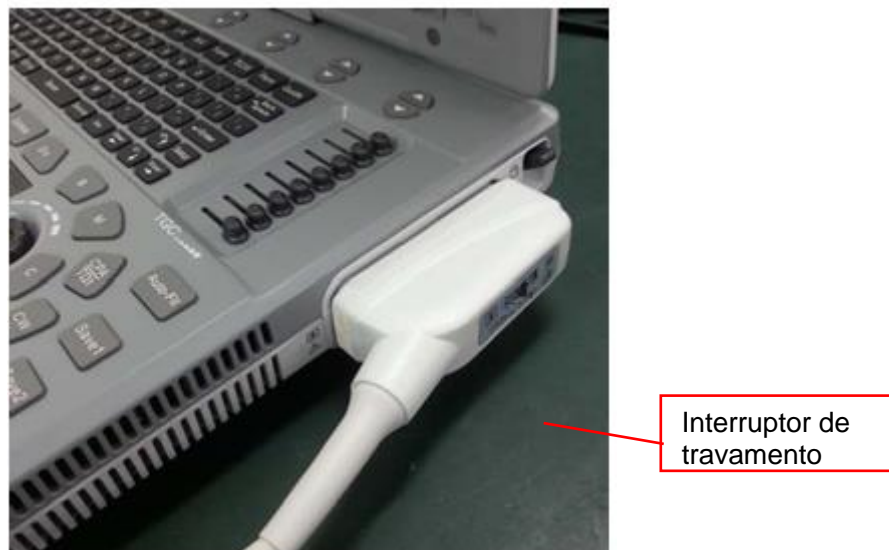
Fig. 4-1 Conexão de um Transdutor
